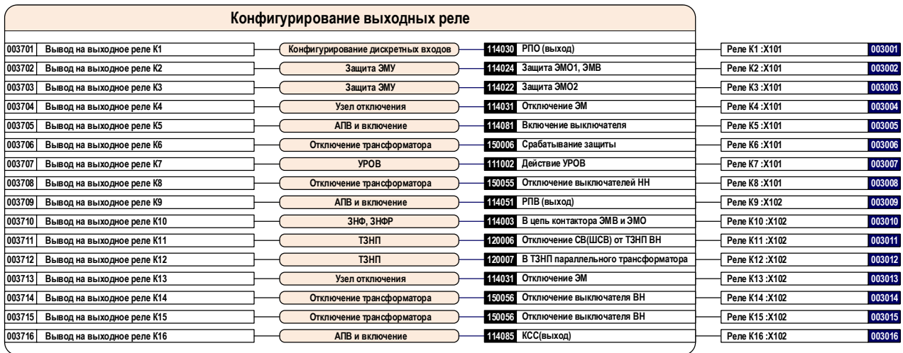
Рисунок 21 - Конфигурирование выходных реле терминала БЭ2704 207 (по умолчанию)
